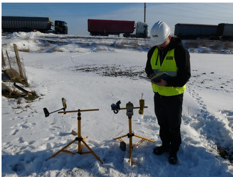
Foto 2.8. Prelevare și măsurare probă de aer - imisii: noxe - NO, NO 2 , SO 2 , CO și CH 4 , particule materiale în suspensie PM 2,5 , PM 10 și PM total , compuși organici volatili (COV) și măsurare condiții meteorologice - punct de monitorizare P2
