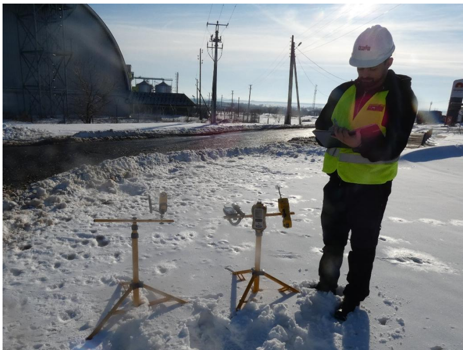
Foto 2.2. Prelevare și măsurare probă de aer - imisii: noxe - NO, NO 2 , SO 2 , CO și CH 4 , particule materiale în suspensie PM 2,5 , PM 10 și PM total , compuși organici volatili (COV) și măsurare condiții meteorologice - punct de monitorizare P 0
