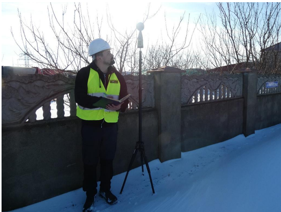
Foto 2.9. Măsurare nivel de zgomot la receptor sensibil - în dreptul punctului de monitorizare P2
