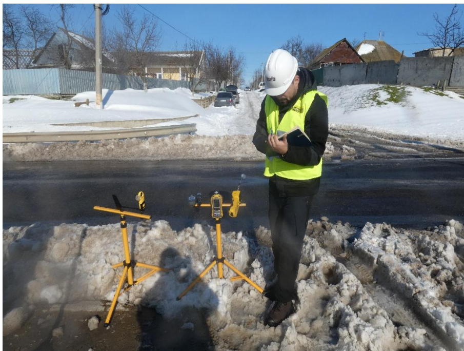
Foto 2.12. Prelevare și măsurare probă de aer - imisii: noxe - NO, NO 2 , SO 2 , CO și CH 4 , particule materiale în suspensie PM 2,5 , PM 10 și PM total , compuși organici volatili (COV) și măsurarea condițiilor meteorologice - punct de monitorizare P3
