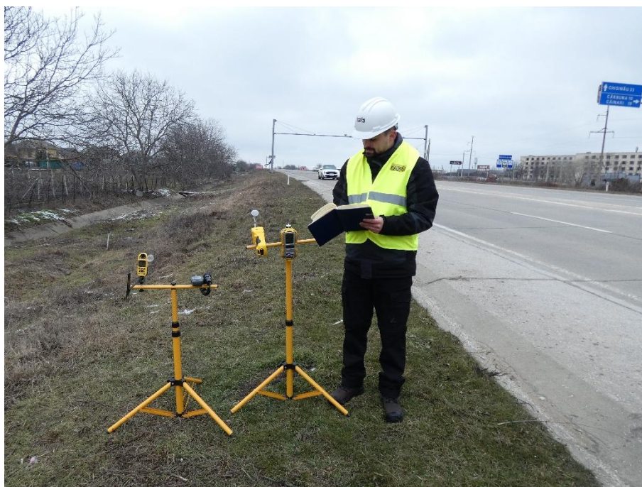
Foto 2.48. Prelevare și măsurare probă de aer - imisii: noxe - NO, NO 2 , SO 2 , CO și CH 4 , particule materiale în suspensie PM 2,5 , PM 10 și PM total , compuși organici volatili (COV) și măsurare condiții meteorologice - punct de monitorizare P15
