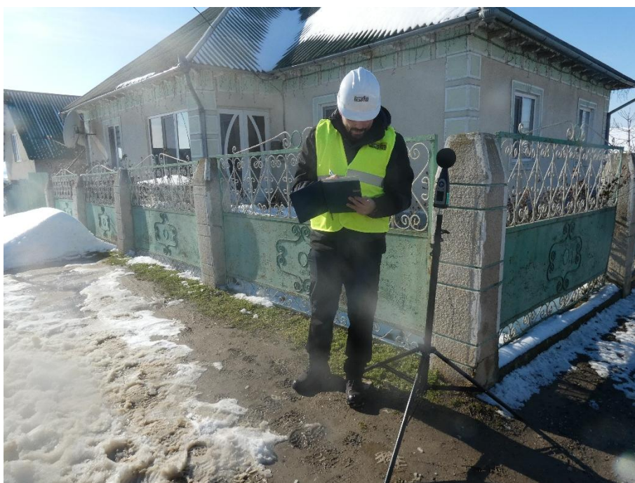
Foto 2.13. Măsurare nivel de zgomot la receptor sensibil - în dreptul punctului de monitorizare P3
