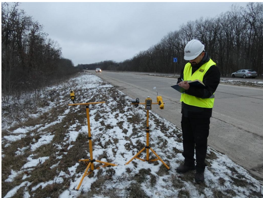
Foto 2.42. Prelevare și măsurare probă de aer - imisii: \text{NO}_2 și \text{SO}_2 , particule materiale în suspensie \text{PM}_{10} , compuși organici volatili (COV) și măsurare condiții meteorologice - P13
