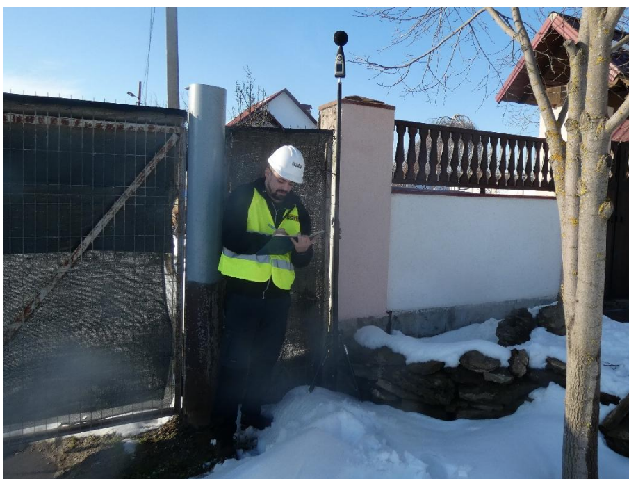
Foto 2.3. Măsurare nivel de zgomot la receptor sensibil - în dreptul punctului de monitorizare P 0
