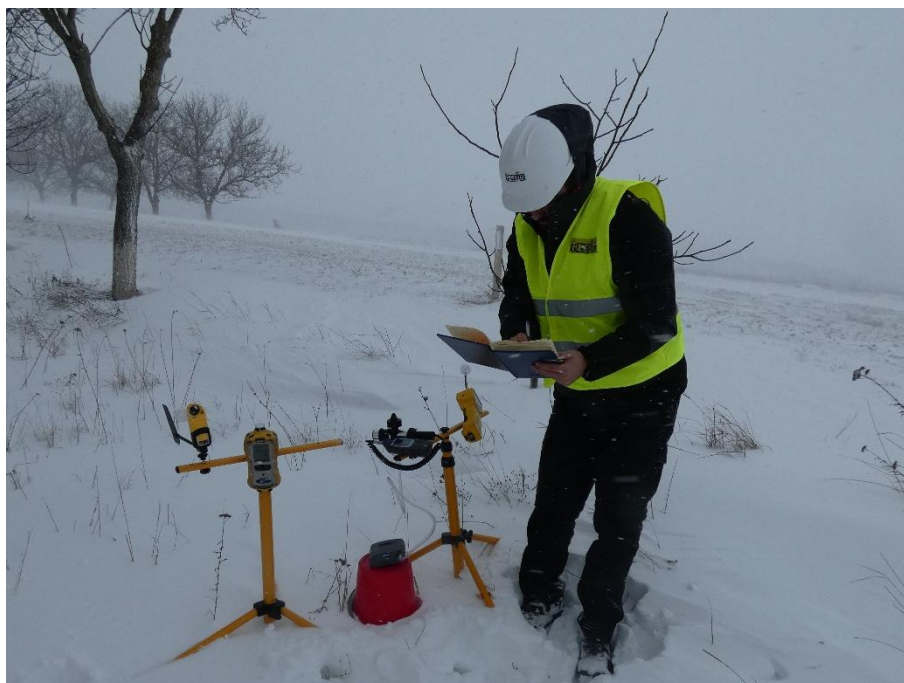
Foto 2.18. Prelevare și măsurare probă de aer - imisii: noxe - NO, NO 2 , SO 2 , CO și CH 4 , particule materiale în suspensie PM 2,5 , PM 10 și PM total , compuși organici volatili (COV) și măsurarea condițiilor meteorologice - punct de monitorizare P5
