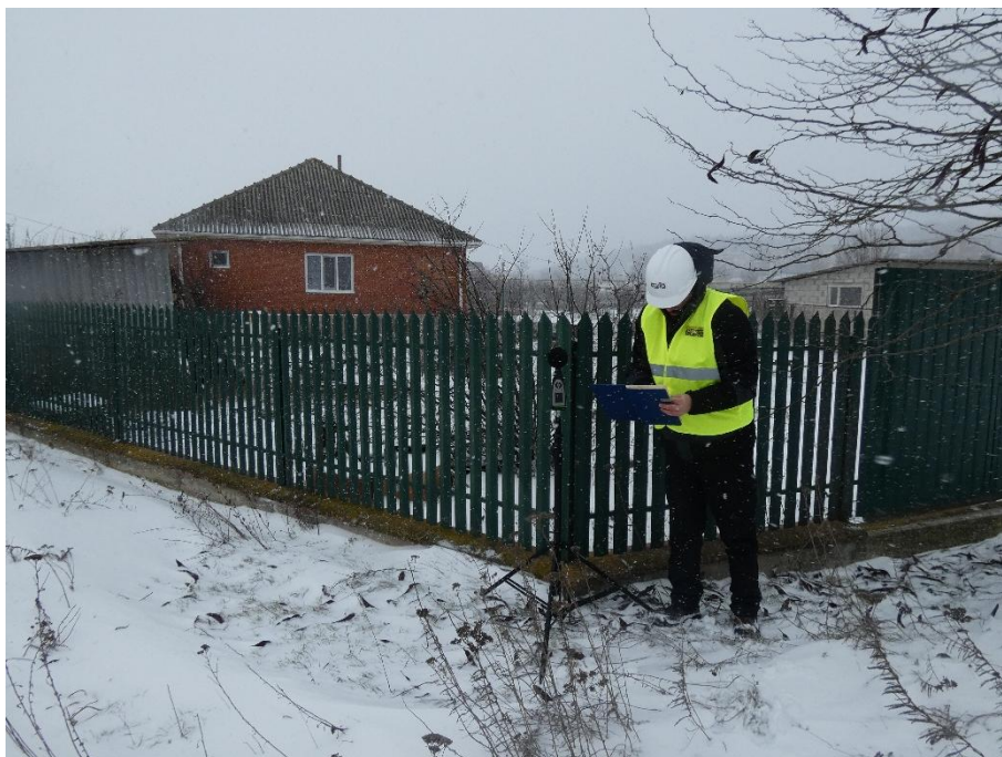
Foto 2.25. Măsurare nivel de zgomot la receptor sensibil - în dreptul punctului de monitorizare P7
