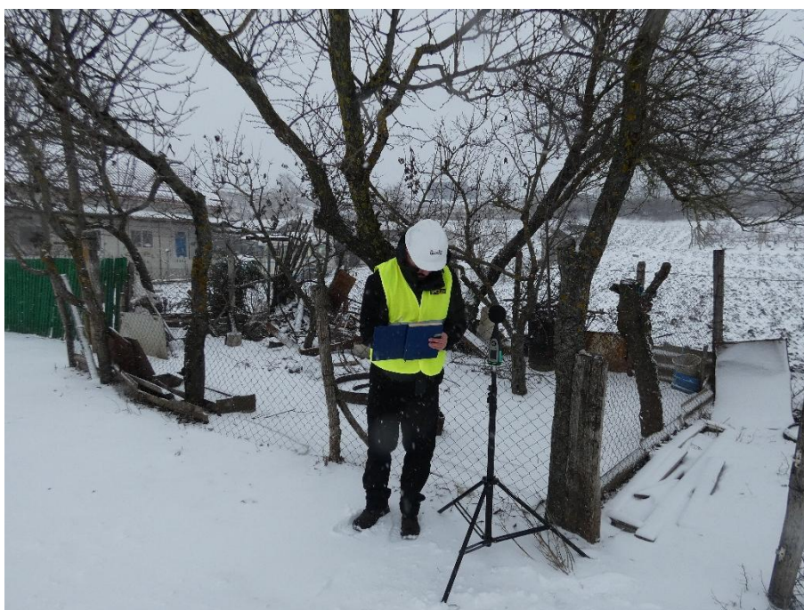
Foto 2.37. Măsurare nivel de zgomot la receptor sensibil - în dreptul punctului de monitorizare P11
