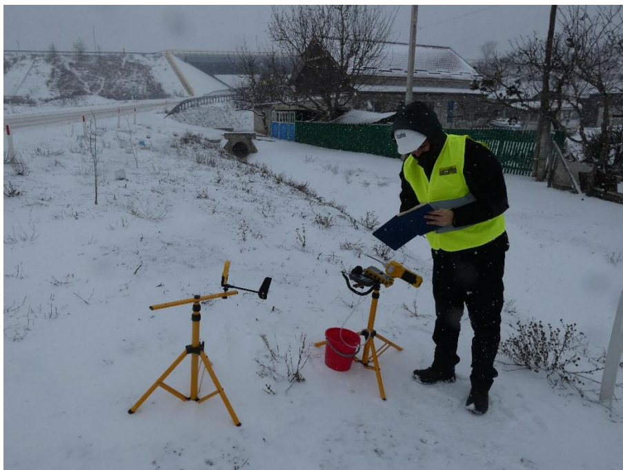
Foto 2.36. Prelevare și măsurare probă de aer - imisii: noxe - NO, NO 2 , SO 2 , CO și CH 4 , particule materiale în suspensie PM 2,5 , PM 10 și PM total , compuși organici volatili (COV) și măsurare condiții meteorologice - punct de monitorizare P11
