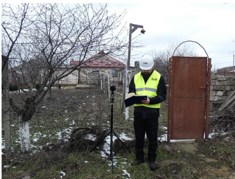
Foto 2.49. Măsurare nivel de zgomot la receptor sensibil - în dreptul punctului de monitorizare P15
