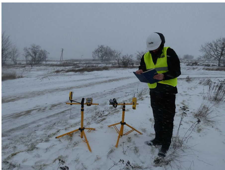
Foto 2.24. Prelevare și măsurare probă de aer - imisii: noxe - NO, NO 2 , SO 2 , CO și CH 4 , particule materiale în suspensie PM 2,5 , PM 10 și PM total , compuși organici volatili (COV) și măsurare condiții meteorologice - punct de monitorizare P7
