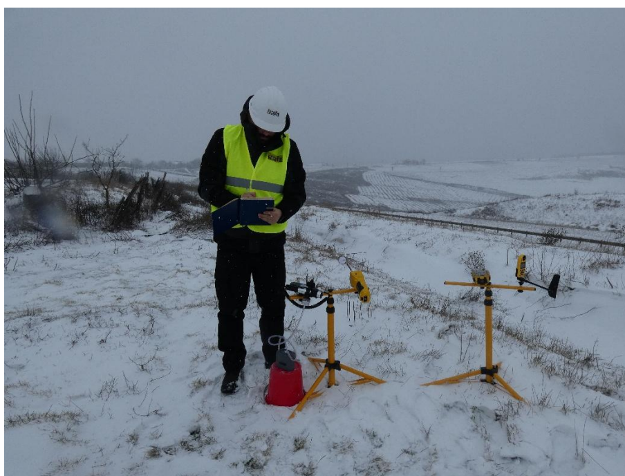
Foto 2.33. Prelevare și măsurare probă de aer - imisii: noxe - NO, NO 2 , SO 2 , CO și CH 4 , particule materiale în suspensie PM 2,5 , PM 10 și PM total , compuși organici volatili (COV) și măsurare condiții meteorologice - punct de monitorizare P10
