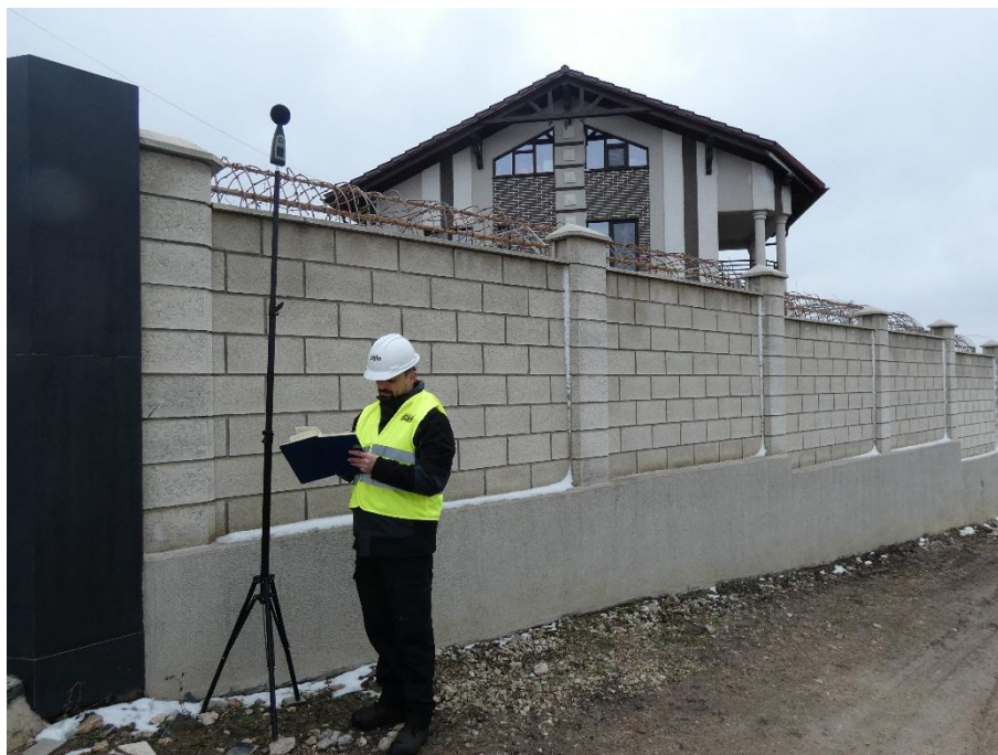
Foto 2.52. Măsurare nivel de zgomot la receptor sensibil - în dreptul punctului de monitorizare P16
