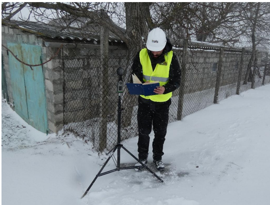
Foto 2.19. Măsurare nivel de zgomot la receptor sensibil - în dreptul punctului de monitorizare P5
