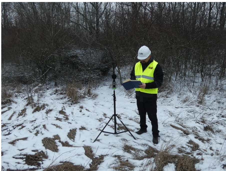
Foto 2.43. Măsurare nivel de zgomot - în dreptul punctului de monitorizare P13
