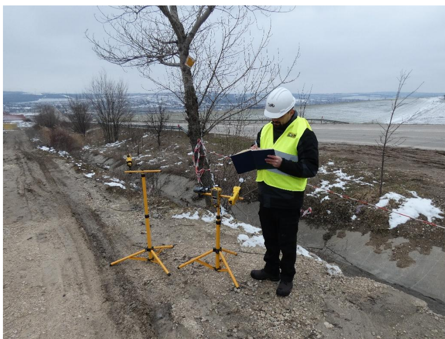
Foto 2.51. Prelevare și măsurare probă de aer - imisii: noxe - NO, NO 2 , SO 2 , CO și CH 4 , particule materiale în suspensie PM 2,5 , PM 10 și PM total , compuși organici volatili (COV) și măsurare condiții meteorologice - punct de monitorizare P16
