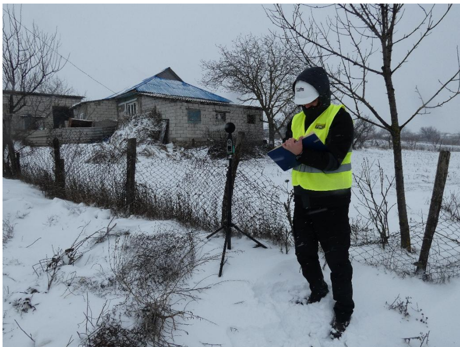
Foto 2.34. Măsurare nivel de zgomot la receptor sensibil - în dreptul punctului de monitorizare P10
